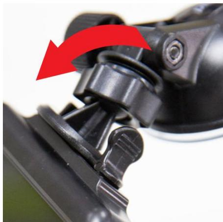
5. Una vez que el DrivePro esté en la mejor posición, gire la unión articulada de ajuste hacia la derecha para asegurarse de que el DrivePro está bien fijado en la posición deseada.
