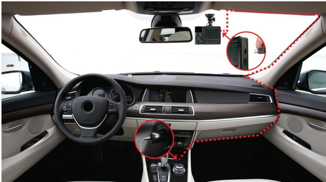
1. Conecte el extremo pequeño del adaptador de coche al conector USB del DrivePro.
